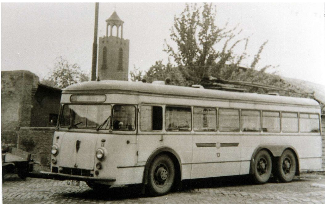
Nach Entfernung des nur aufgeschraubten Oberdecks fuhr der ehemalige HHA-Obus 332 mit der neuen Wagennummer 13 noch einige Jahre durch Erfurt.
