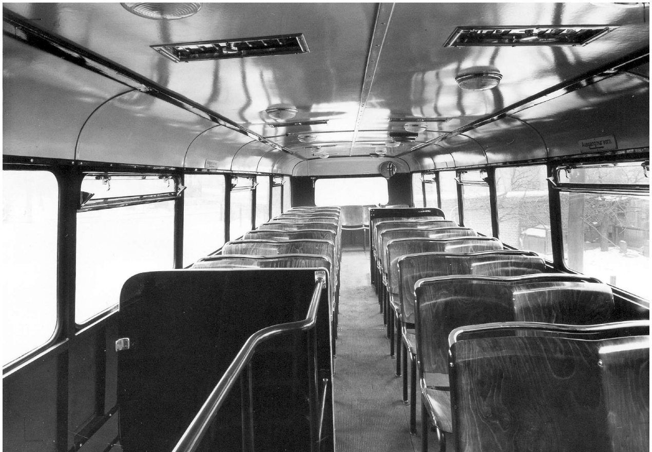
Unter- und Oberdeck des Obus 331. Über 100 Fahrgäste konnten mitfahren. 25 Sitze im Unterdeck und 37 Sitzplätze im Oberdeck, sowie 41 Stehplätze im Unterdeck standen zur Verfügung. Wie bei der Straßenbahn kamen Durofol-Bestuhlung zum Einbau. Foto: HHA
